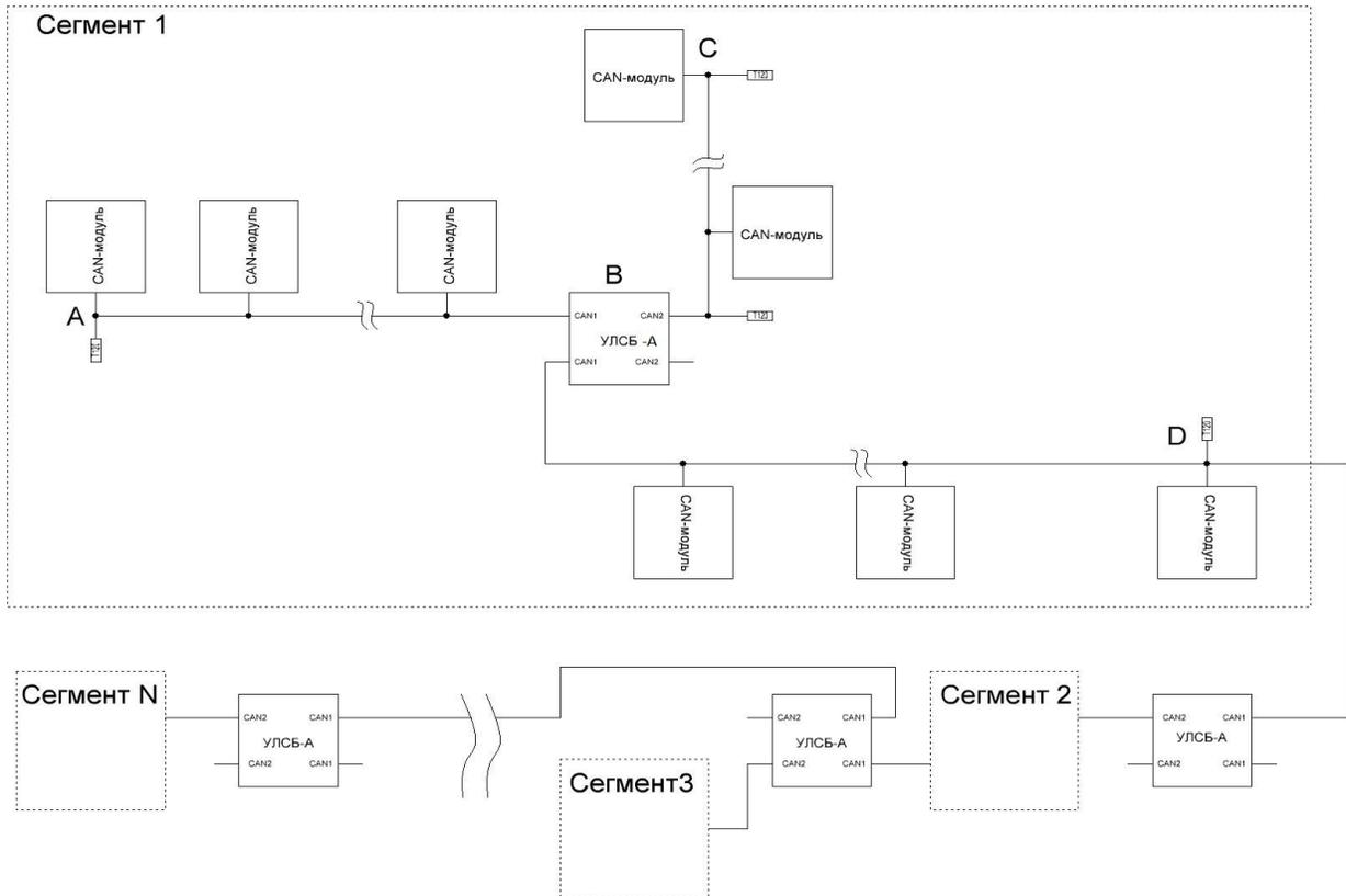
**Рисунок 2** Схема сети устройств СБК увеличенной длины
